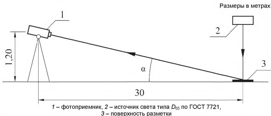
Рисунок 12 – Условия определения удельного коэффициента светотражения при диффузном дневном или искусственном освещении
